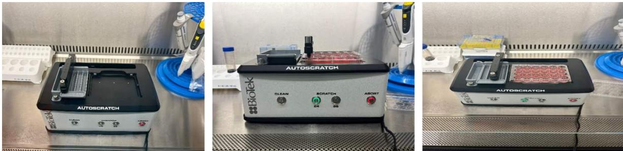
Figura 4.12. Strumento per la creazione di ferite BioTek AutoScratch
