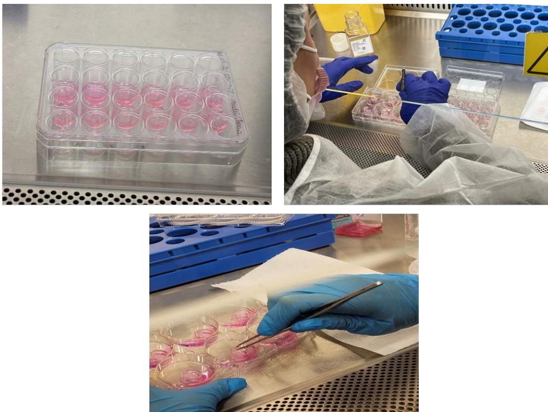
**Figura 4.15.** Manipolazione dei tessuti EpiDerm ricostruiti in 3D al momento della ricezione. (iii) anche il controllo positivo (PC) - Triton X-100 1% e il controllo negativo (NC) - acqua ultrapura vengono aggiunti sulla parte superiore degli inserti con i tessuti e incubati per 18 ore;
