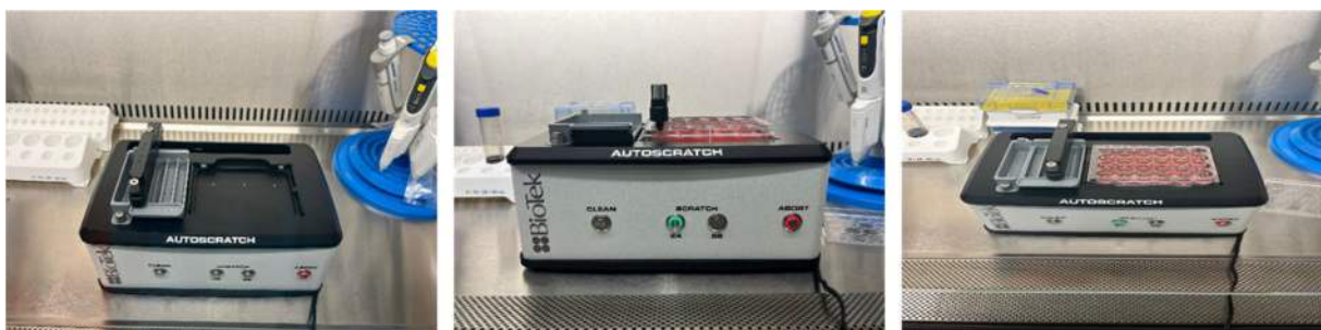
Figura 4.12. Instrument BioTek AutoScratch folosit pentru a face incizii.
